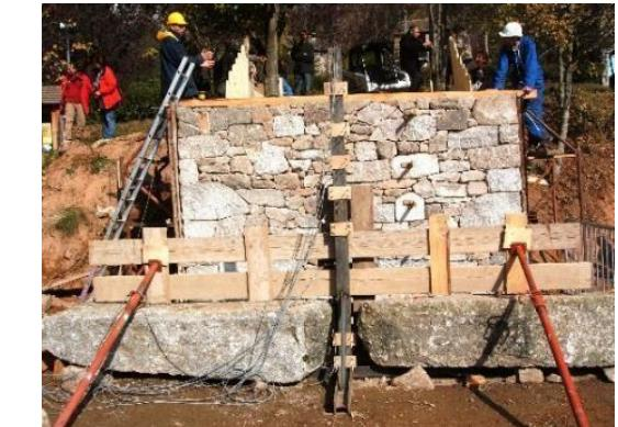
**2017-2022 :** plusieurs essais à échelle 1 pour augmenter la base de données en vue de créer un outil de dimensionnement simple pour l'ingénieur
