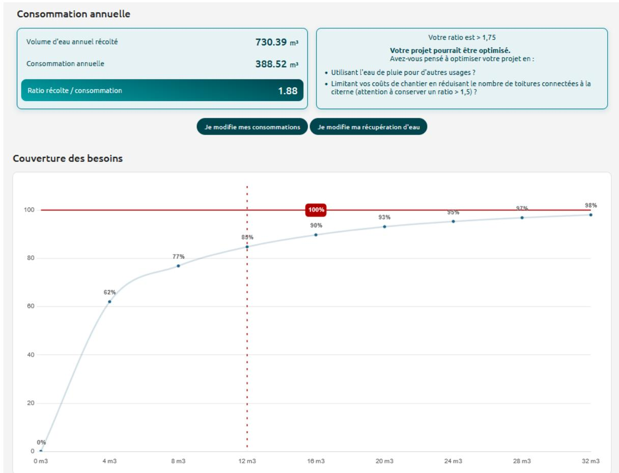
*Un graphique illustrant la taille optimale d'une cuve en fonction d'un usage et d'une toiture donnée.*
